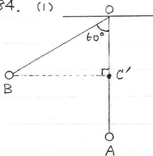
糸の長さを  $l$  ( $= 40 \text{ cm} = 0.40 \text{ m}$ ) とすると、最低点 A から B の高さ  $h$  は
